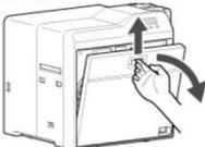
2 カセットボタンを押しながら、インクリボンカセット（右側）を取り出し、インクリボンをははずす
