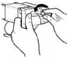
5 カセットをガイドレールに沿って“カチッ”と音がするまで挿入し、プリンタードアを閉める
