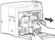
3 カセットボタンを押しながら、再転写フィルムカセット（左側）を取り出し、再転写フィルムをははずす
